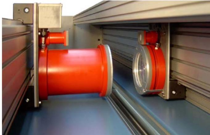
Fig. 10: Structure Detector SD1 - Traversierung CCD camera system
